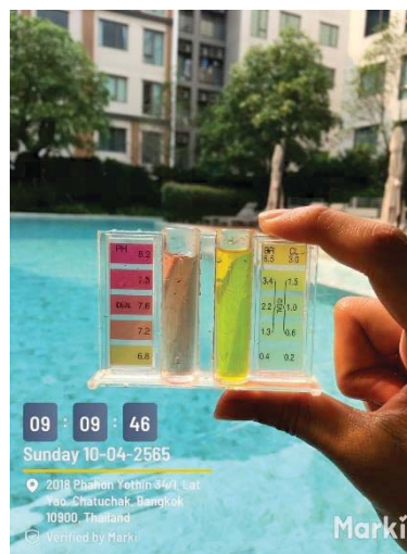
ภาพที่ 3.5.4-2 การตรวจวัด pH และ \text{Cl}_2 สระว่ายน้ำ
